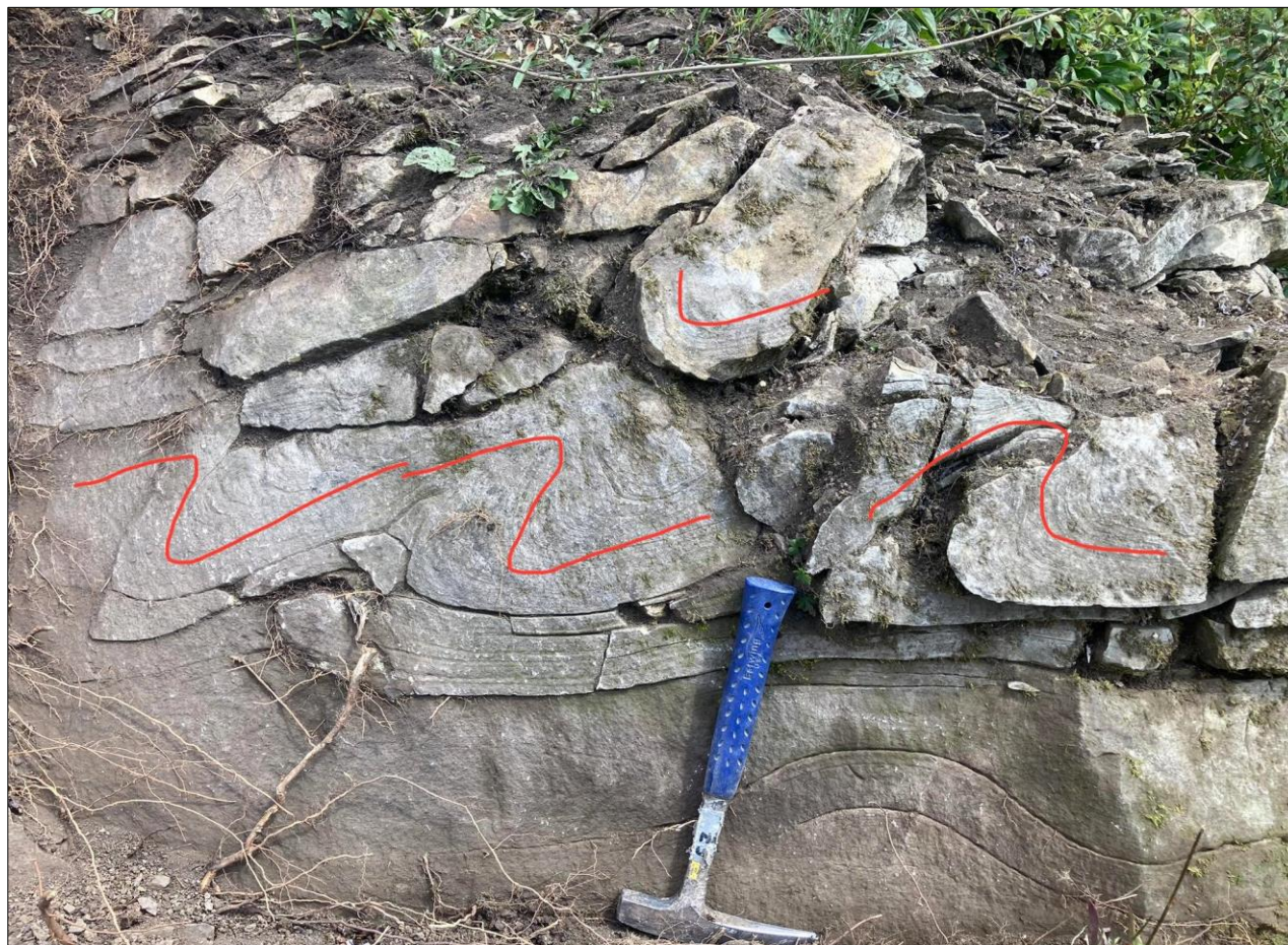
Obrázek 3 Konvolutní zvrstvení v pískovcích viditelné v zářezu na levé straně ve staničení cca v km 20,500
